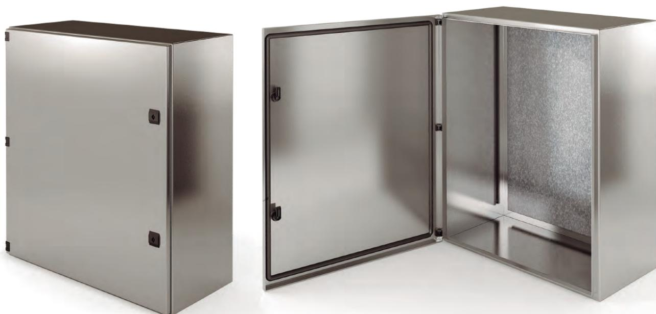
Se fabrican en acero inoxidable AISI 304. Con el fin de garantizar un elevado índice de estanqueidad se le aplica a la puerta un burlete de poliuretano de manera continua que incide sobre un laberinto rematado en labio bota agua de nuevo diseño.
